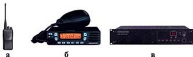
Рисунок 4 – Портативная радиостанция типа Kenwood TK-3000M (а), передвижные радиостанции типа «Kenwood NX-720HGK» (б), стационарная радиостанция «Kenwood TKR-D710E» (в)
